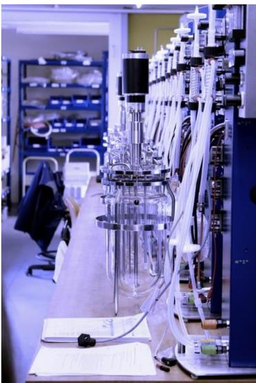
Abbildung 2: RALF, Aufbau eines RALF Reaktors, besonders hervorzuheben ist dem Modulaufbau
